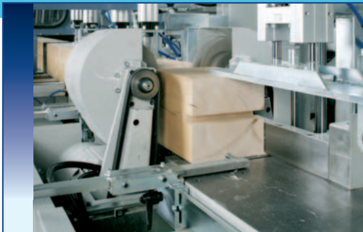
Gruppo di fresatura verticale Vertical notching unit Grupo de fresado vertical Groupe de fraisage vertical Узел формирования вертикального паза для соединения бруса в замок
